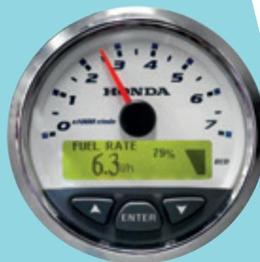
L'ECOMO, controllando automaticamente la miscela aria-carburante consente di ottenere una drastica riduzione dei consumi a velocità di crociera.
